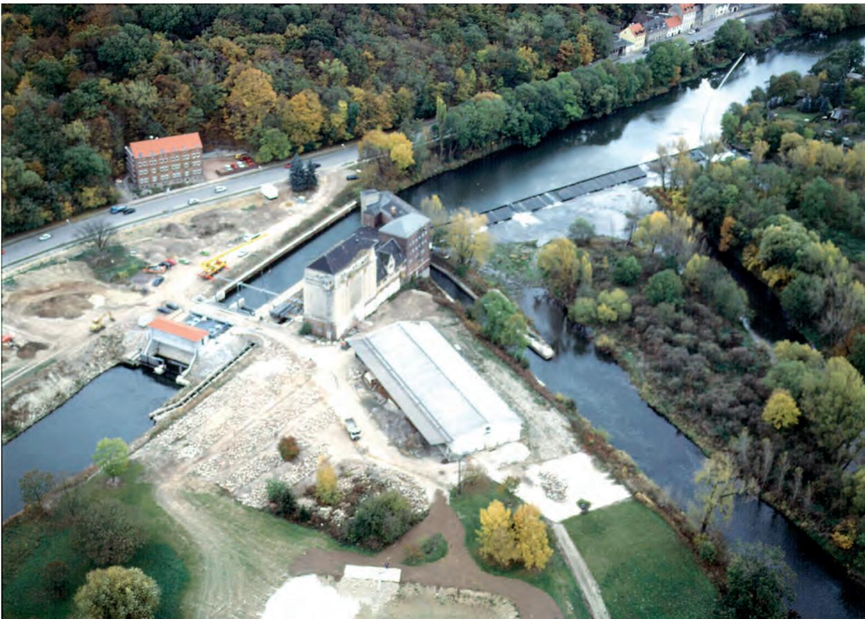
Wasserkraftanlage mit Fischwechsellanlagen an der Saale in Weißenfels
